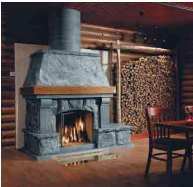
Топка камина может быть открыта с одной стороны (односторонний камин), с двух сторон (двухсторонний камин), с трех (трехсторонний камин) или со всех сторон (островной или отдельно стоящий камин).
